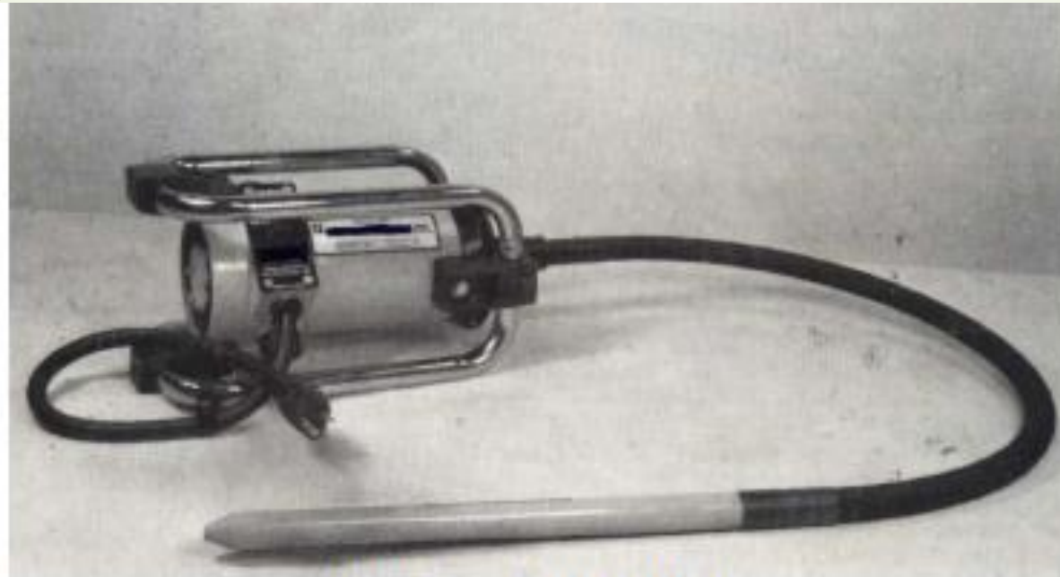
شكل (10) هزاز خرسانة داخلي
