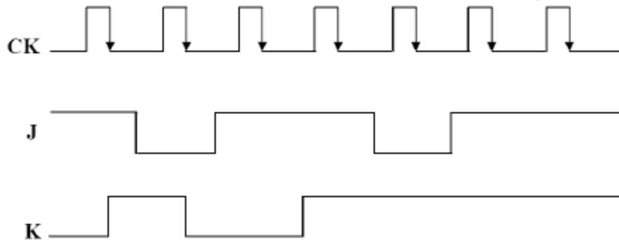
4) ارسم شكل نبضات الخرج (Q) لدائرة القلاب من النوع T والتي يتغير الخرج لها عند الحافة السالبة لنبضات التزامن (negative edge trigger) إذا كان شكل نبضات الدخل كما هو موضح بالشكل. افترض أن دائرة القلاب تعطي خرجاً  $Q=0$  قبل وصول أول نبضة من نبضات التزامن.
