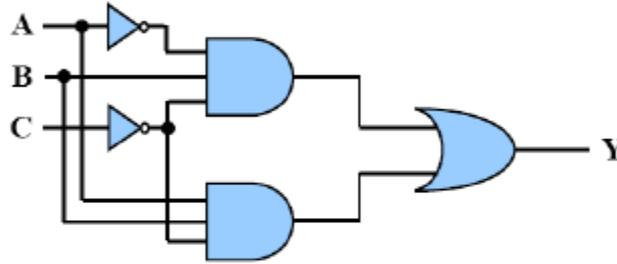
الشكل (2- 21) الدائرة المنطقية للتعبير البوليئي  $\overline{A}B\overline{C} + A\overline{B}C$ .
