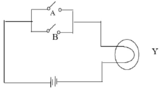
شكل (٢- ٥) الدائرة الكهربائية لبوابة OR شكل (٢- ٦) الرمز المنطقي لبوابة "أو" OR
