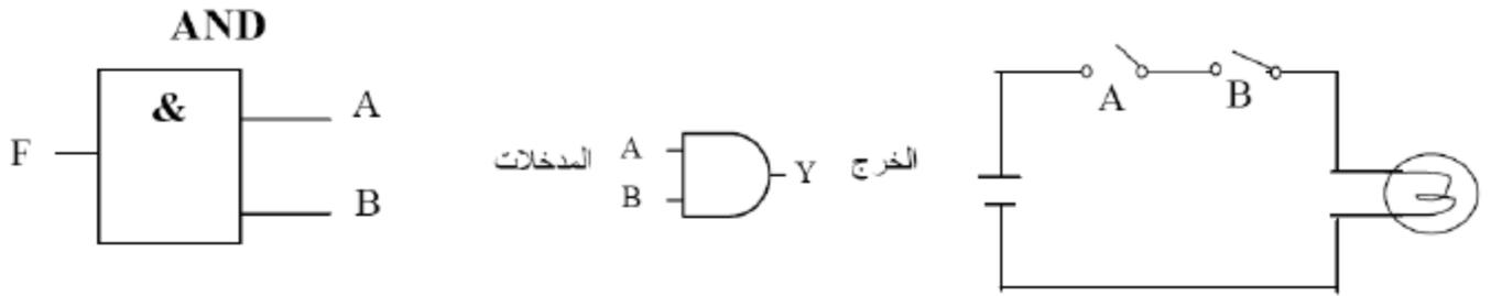
شكل (٢- ١) الدائرة الكهربائية لبوابة AND شكل (٢- ٢) الرمز المنطقي لبوابة "و" AND
