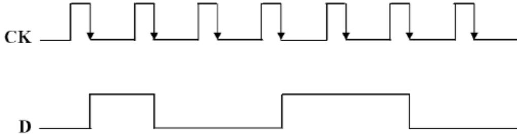
3) ارسم شكل نبضات الخرج (Q) لدائرة القلاب JK والتي يتغير الخرج لها عند الحافة السالبة لنبضات التزامن (negative edge trigger) إذا كان شكل نبضات الدخل كما هو موضح بالشكل. افترض أن دائرة القلاب تعطي خرجاً  $Q=0$  قبل وصول أول نبضة من نبضات التزامن.
