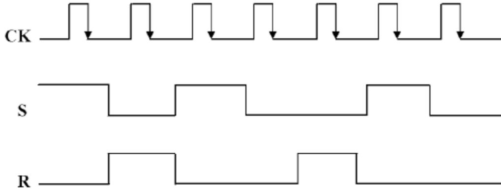
2) ارسم شكل نبضات الخرج (Q) لدائرة القلاب من النوع D والتي يتغير الخرج لها عند الحافة الموجبة لنبضات التزامن (positive edge trigger) إذا كان شكل نبضات الدخل كما هو موضح بالشكل. افترض أن دائرة القلاب تعطي خرجاً  $Q=0$  قبل وصول أول نبضة من نبضات التزامن.
